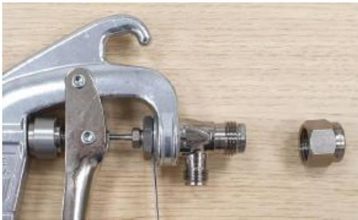
Lösen Sie die Befestigungsschraube der Düsedüse
