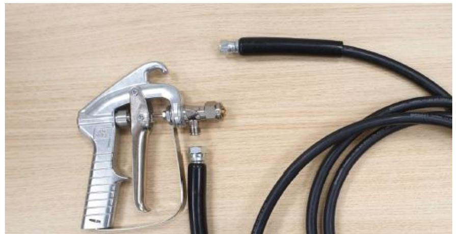
Achtung! Wenn die Arbeit mit Con4's Maxi beendet ist, das Ventil nicht schließen! Dies kann dazu führen, dass der Klebstoff austrocknet und die weitere Arbeit erschwert wird
